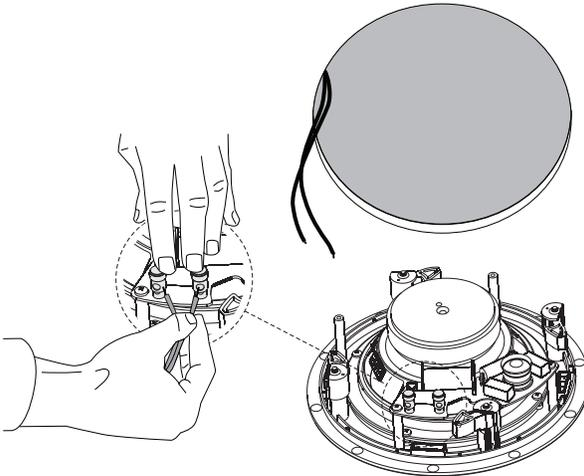
3. Установите акустическую систему в вырезанное отверстие и затяните фиксирующие зажимы.
