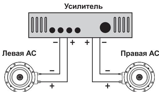
При использовании АС серии **YC** в системах домашнего кинотеатра акустические системы следует подключать к выходным клеммам и разъемам соответствующих каналов усилителя – фронтальных, центрального и тыловых.
