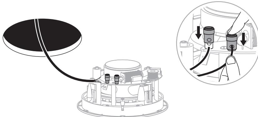
3. Установите акустическую систему в вырезанное отверстие и затяните фиксирующие зажимы.
